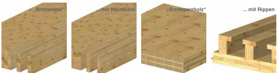
Abb. 1 Verschiedene Arten von Holzmassivelementen. Die Variante „Brettsperrholz“ steht in dieser Broschüre im Fokus.
