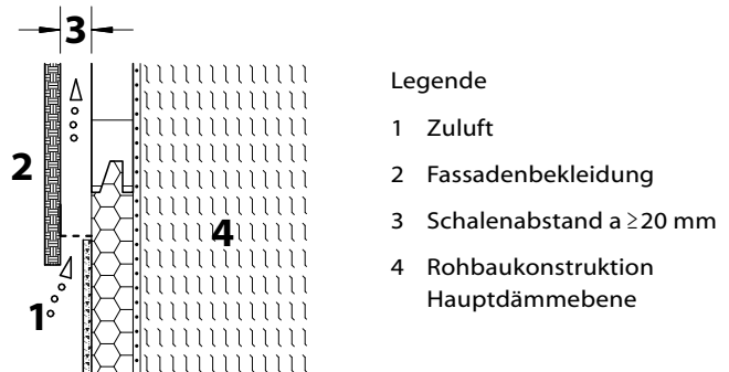
Abb. 53: Die Bekleidung wird auf einer Traglattung befestigt. Die Ebene der Traglattung bildet die notwendige Luftschicht.
