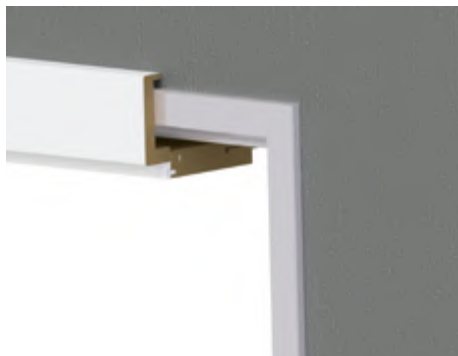
Die Konstruktion der Reno-Zarge ummantelt die alte Stahlzarge: Die schmale Bandtasche der Zarge verhindert Durchgangsvorlust, die breite Bekleidung reduziert Nacharbeiten an der Wand.
